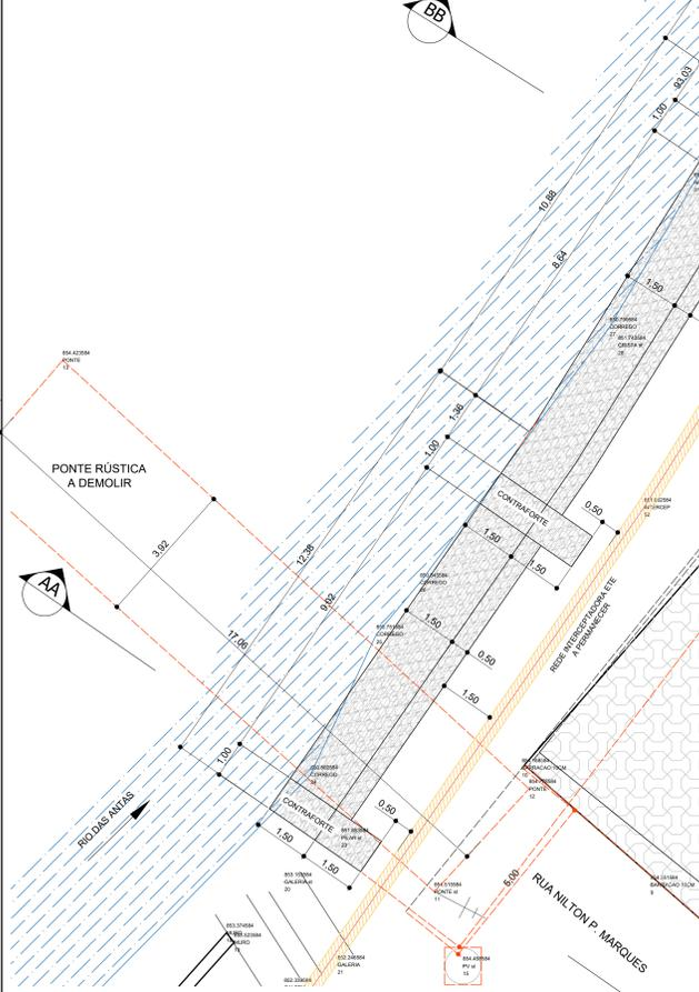
1 PLANTA DE LOCAÇÃO MURO DE ARRIMO
