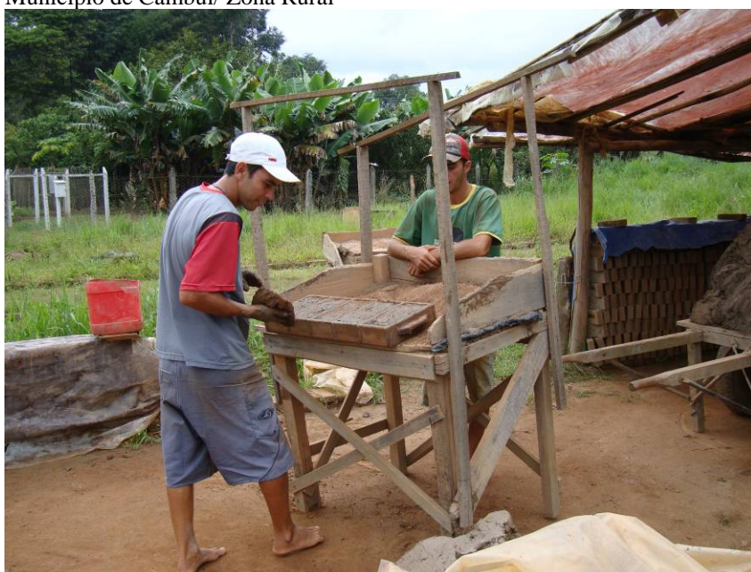
Foto 02 – Olaria Itaim Fazendo o tijolo Município de Cambuí / Zona Rural
