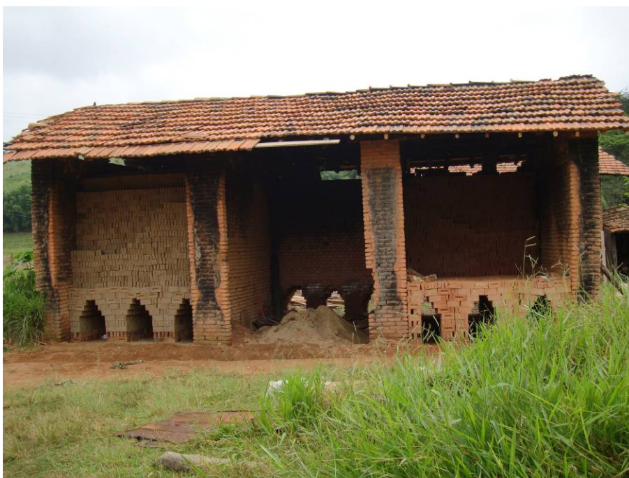
Foto 04 – Olaria Itaim Forno onde se faz a queima do tijolo Município de Careagu / distrito sede
